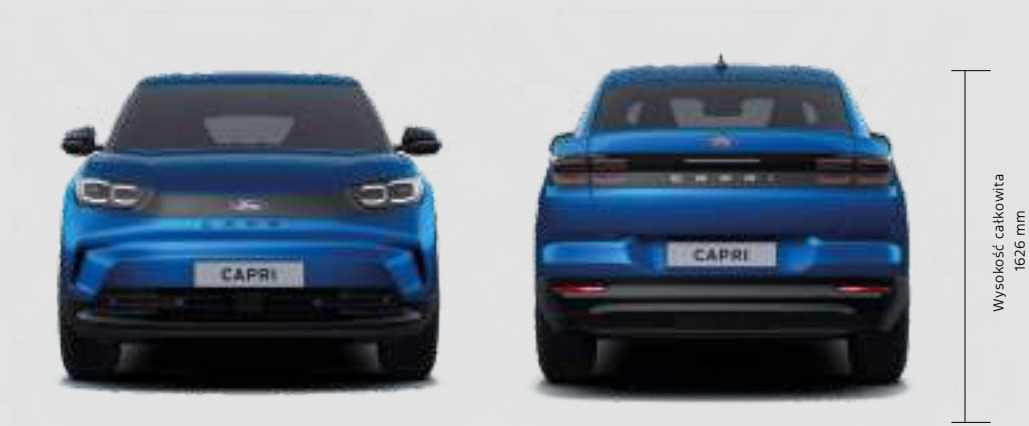
Szerokość całkowita z lusterkami: 2063 mm Szerokość całkowita ze złożonymi lusterkami: 1946 mm Wysokość całkowita 1626 mm
